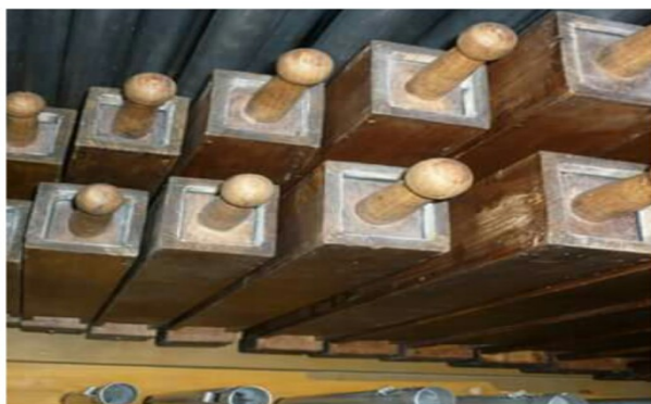
píšťalový fond po umytí a oprave
