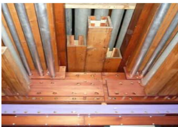
znečistený a poškodený píšťalový fond pred a po oprave
