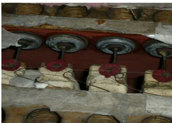
znečistený a poškodený pišťalový fond pred a po oprave, staré výpustkové vzdušnice a nové elektromagnetické vzdušnice
