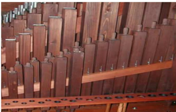
umytý a opravený píšťalový fond nástroja
