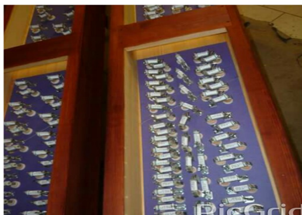
znečistený a poškodený pišťalový fond pred a po oprave, staré výpustkové vzdušnice a nové elektromagnetické vzdušnice
