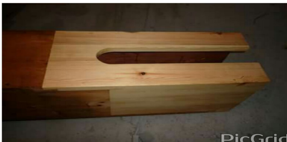
oprava drevených píšťal, výroba novej ladičky
