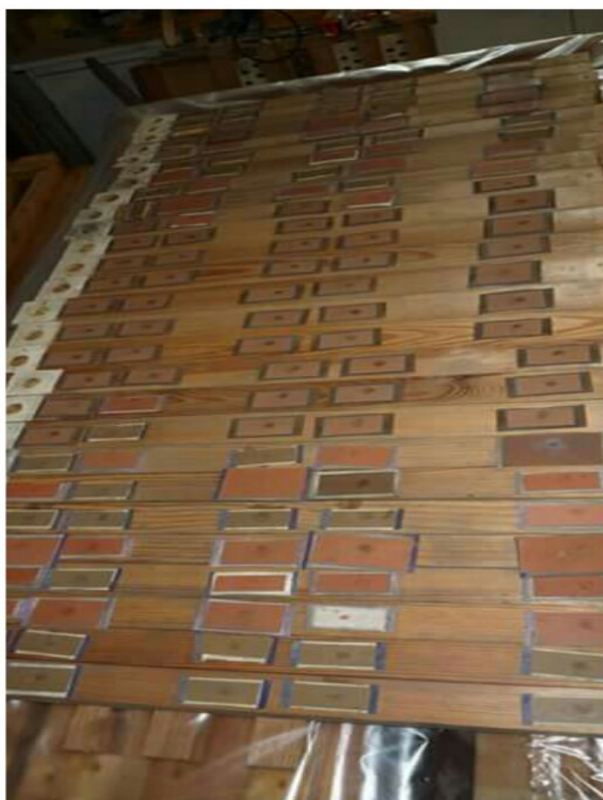
tónové lišty pred a po oprave, výmena nových membrán
